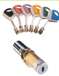
Le cylindre est verrouillé par deux bascules en acier et se déverrouille grâce à ses deux aimants situés en bout de clé. Ses garnitures intérieures sont conçues pour empêcher toutes tentatives d'ouverture par crochetage. Une protection en acier traité vient renforcer sa haute résistance aux attaques par sciage, perçage et arrachement.
